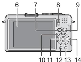
El joystick se hace funcionar de dos maneras: puede moverse hacia arriba, abajo, a la izquierda y a la derecha para llevar a cabo una operación o bien puede ser pulsado para seleccionar. En estas instrucciones de funcionamiento él se representa de la manera mostrada en la figura a continuación o se describe con ▲/▼/◀/▶.
