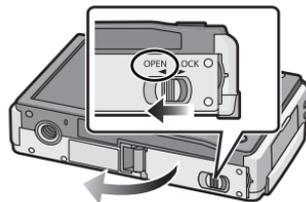
**2** Batteria: Inserirla fino in fondo, facendo attenzione che sia orientata correttamente. Tirare la leva **A** nella direzione indicata dalla freccia per rimuovere la batteria.
