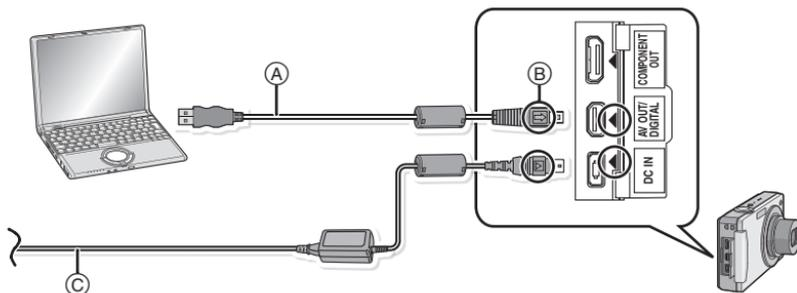
(A) Cavo di connessione USB (in dotazione)
