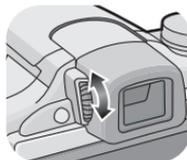
**Schauen Sie in den Sucher und drehen Sie das Einstellrad zur Dioptrienkorrektur, bis die bestmögliche Anzeige erreicht ist.**
