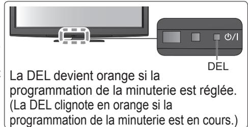
La DEL devient orange si la programmation de la minuterie est réglée. (La DEL clignote en orange si la programmation de la minuterie est en cours.)
