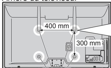
Orifices pour l'installation de l'applique de suspension au mur
