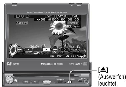
Bei erleuchteter Auswerttaste **[▲]** keine Disc einsetzen, da bereits eine geladen ist.
