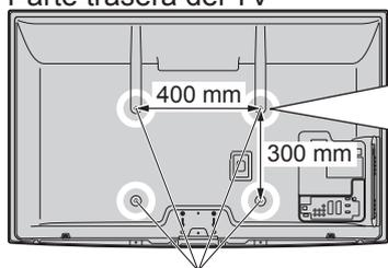
Agujeros para la instalación del abrazadera de suspensión de pared
