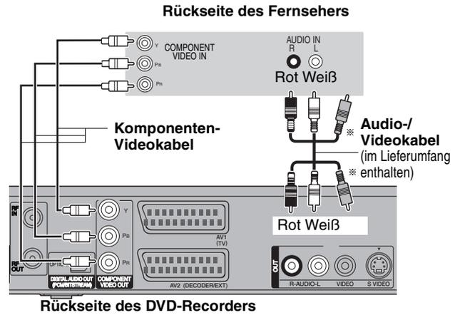
COMPONENT VIDEO-Buchsen liefern wahlweise ein Zeilensprung- oder ein Progressive-Ausgangssignal (⇒ 82) für eine noch bessere Bildqualität als mit der Buchse S VIDEO OUT.
