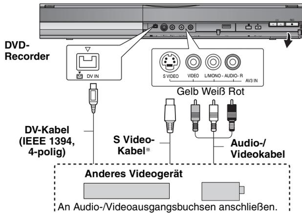
Wenn das andere Gerät nur einen Mono-Audioausgang besitzt Schließen Sie den Videorecorder an die AV3-Eingangsbuchse L/MONO an der Gerätevorderseite an.
