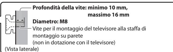
Fori per l'installazione della staffa di montaggio su parete
