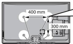
Profondeur de vissage : minimum 17 mm, maximum 22 mm
