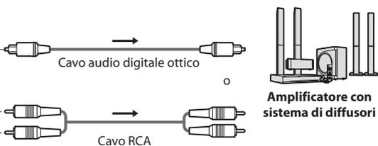
Per fruire del suono multicanale del componente esterno (per es., Dolby Digital 5,1ch), collegare il componente all'amplificatore. Per i collegamenti, leggere il manuale di istruzioni del componente e dell'amplificatore.
