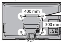
**Profondità della vite: minimo 17 mm, massimo 22 mm**
