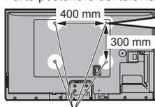
**Profondità della vite: minimo 10 mm, massimo 16 mm**
