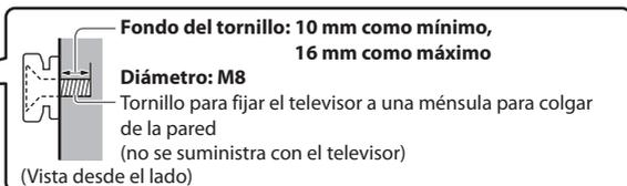
Agujeros para la instalación de la abrazadera de suspensión de pared
