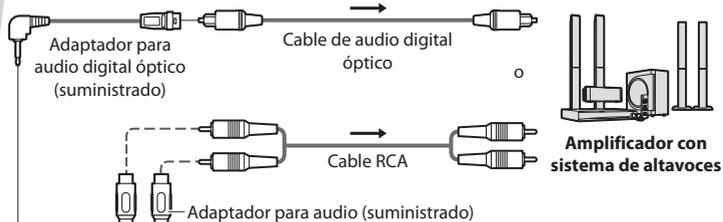
Para disfrutar del sonido del equipo externo en sonido multicanal (por ejemplo Dolby Digital 5.1ch), conecte el equipo al amplificador.
