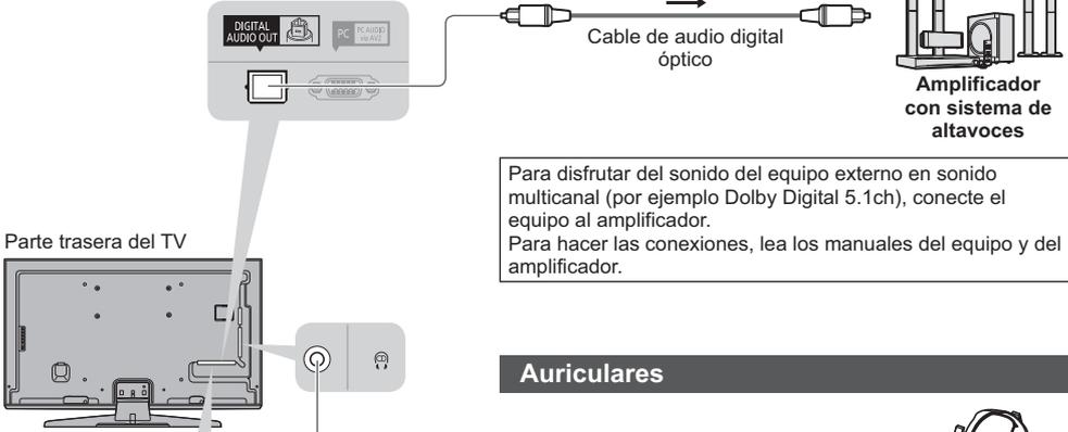
Para disfrutar del sonido del equipo externo en sonido multicanal (por ejemplo Dolby Digital 5.1ch), conecte el equipo al amplificador.
