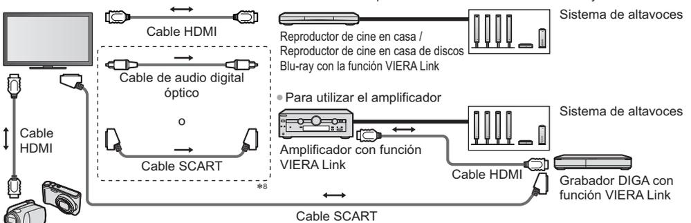
Videocámara HD / Cámara LUMIX con función VIERA Link
