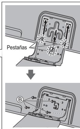
Alinee las 3 pestañas del soporte con las hendiduras de parte trasera del TV e insértelas.
