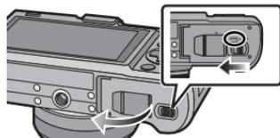
**2** Batterie: Introduisez la batterie jusqu'à ce qu'elle soit verrouillée par le levier (A) en faisant attention au sens dans lequel vous l'introduisez. Tirez le levier (A) dans le sens de la flèche pour retirer la batterie.
