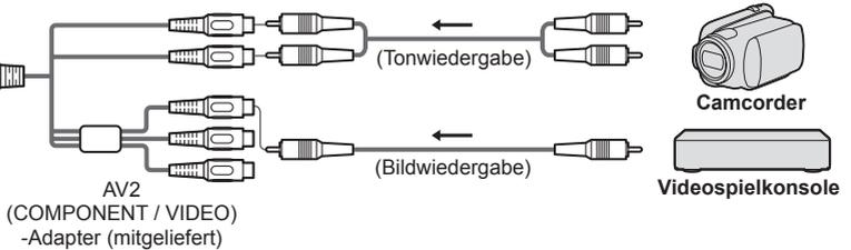
Für den Anschluss an die verschiedenen Buchsen geeignete Zusatzgeräte
