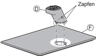
**2 Drehen Sie die Basis (F) um und befestigen Sie das Halsstück (D) mit den Schrauben (B)**
