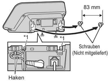
\*1 Wenn die Basisstation an der Wand montiert wird, führen Sie die Kabel nicht durch diese Haken.
