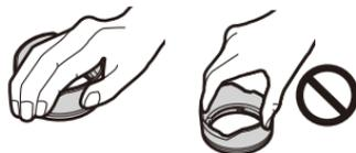
**1 Alinee la marca de ajuste (A) en el lado corto de la visera de lente con la marca en la punta de la lente.**
