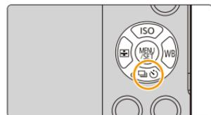
**2** Pulse ◀/▶ para seleccionar el modo de accionamiento y luego pulse [MENU/SET].
