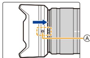
**2 Gire la visera de la lente en la dirección de la flecha hasta que haga clic y alinee la marca de tope (B) en el lado largo de la visera de la lente con la marca en la punta de la lente.**
