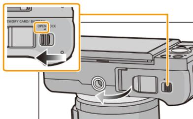
**2** Batería: Con cuidado con la orientación de la batería, insértela hasta que escuche un sonido de bloqueo y luego verifique que se bloquee con la palanca (A).
