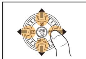
Aunque la cámara funcione utilizando la pantalla táctil, es posible que funcione con el botón cursor y el botón [MENU/SET] si se visualiza una guía como la que se muestra a la derecha.
