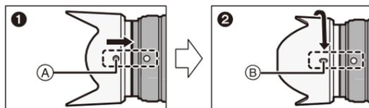
**Colocar la visera de la lente que viene con la lente intercambiable (H-FS45150)**
