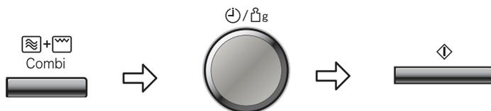
**Premere il pulsante della cottura combinata, per selezionare il livello. Si accende l'indicatore della cottura e sul display viene visualizzato il livello della cottura combinata (1, 2 o 3).**
