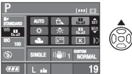
**2 Wählen Sie durch Drehen des Steuer-Wahlschalters (A) den Menüpunkt [FARBTEMPERATUREINST.] und drücken Sie dann [MENU/SET].**
