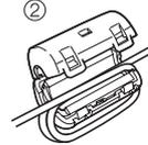
2 Wickeln Sie das Kabel zweimal um den Ferritkern
