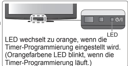
LED wechselt zu orange, wenn die Timer-Programmierung eingestellt wird. (Orangefarbene LED blinkt, wenn die Timer-Programmierung läuft.)
