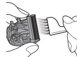
3. Brossez pour enlever tous les poils qui ont été taillés entre la lame fixe et la lame mobile tout en pressant sur le levier de nettoyage ((a)) pour relever la lame mobile.
